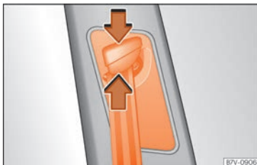
Kuva 92 Etuistuimilla: turvavyön korkeudensäätö.
