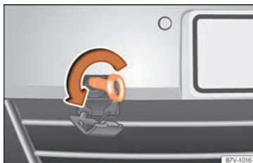
Kuva 74 Etupuskurin oikea puoli: hinaussilmukan kiinnitys.
