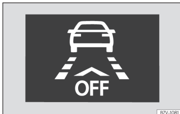
Kuva 260 Mittariston näyttöruutu: ilmoitus siitä, että Front Assist on kytketty pois päältä.
