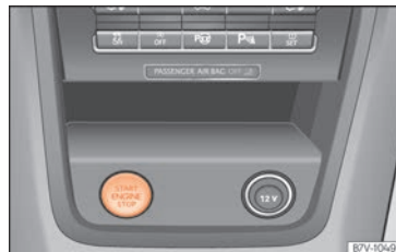
Kuva 237 Keskikonsolissa: avaimettoman lukitus- ja käynnistysjärjestelmän Keyless Access käynnistyspainike. Oikeanpuoleisella ohjauksella varustetussa autossa järjestys on symmetrinen.
