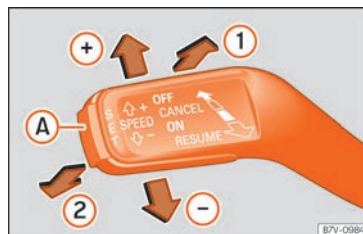
Kuva 49 Ohjauspyörän vasemmalla puolella: vakionopeussäätimen käyttökytkimet.
