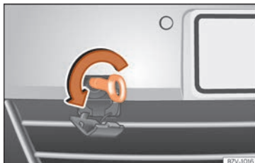
Kuva 105 Etupuskurin oikea puoli: hinaussilmukan kiinnitys.
