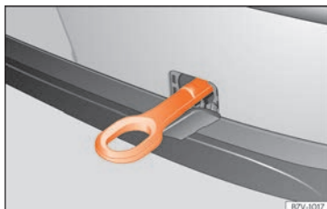
Kuva 75 Takapuskuriin oikealle kiinnitetty hinaussilmukka.
