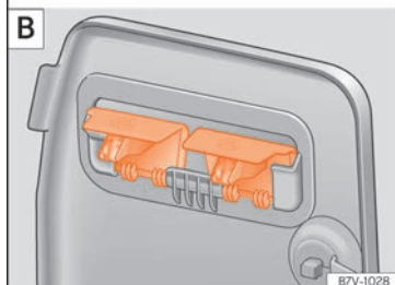
Kuva 169 Tavaratilanpeitteen kiinnityspaikan peitelevyn irrotus A ja asettaminen talteen B.
