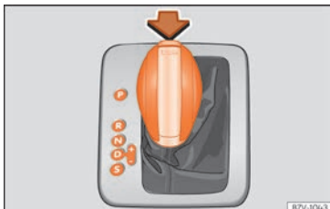
Kuva 51 Automaattivaihteisto: valitsinvivun asennot.
