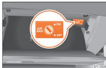
Kuva 29 Hansikaslokerossa, etumatkustajan puolella: avainkytkin etumatkustajan turva- tyyny kytkeäiseksi pois/päälle.
