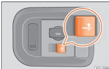
Kuva 280 Tavaratilassa oikealla: painike vetokoukun sähköistä kääntämistä varten.
