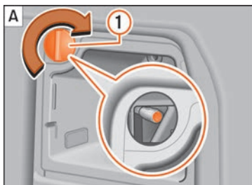
Kuva 116 Takavalon korissa: polttimonpidikkeen irrotus. ① – ④ lukituskiekkeet.
