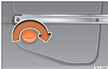
Kuva 288 AdBlue-säiliö tavaratilassa vasemmalla olevan kannen takana.
