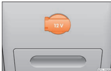
Kuva 197 Keskkikonsolin takaosassa: 12 V:n virranulosotto.
