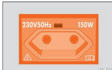
Kuva 198 Keskkikonsolin takaosassa: 230 voltin europistorasia.
