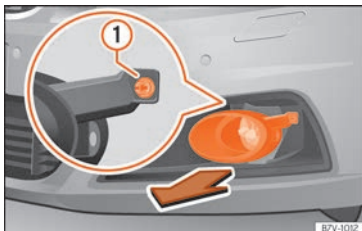
Kuva 111 Etupuskurin oikea puoli: valoumpion irrotus.
