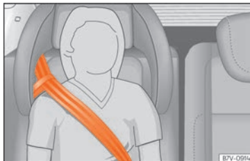
Kuva 98 Integroitu lastenistuin: turvavyön kulku ja ohjainlenkki.
