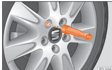
Kuva 73 Pyörän vaihto: pyöränpulttien irrotus ruuvitaltan kahvalla.
