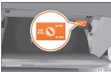
Kuva 94 Hansikaslokerossa, etumatkustajan puolella: avainkytkin etumatkustajan turvatyynyn kytkemiseksi pois/päälle.
