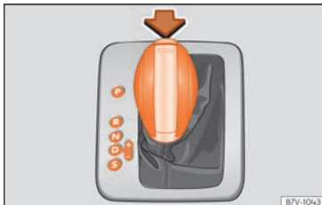
Kuva 241 Automaattivaihteiston valitsinvipu lukkopainikkeineen (nuoli).
