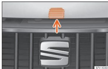
Kuva 13 Vipu konepellin alapuolella.
