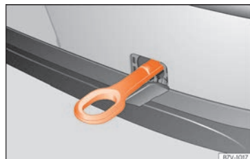
Kuva 106 Takapuskuriin oikealle kiinnitetty hinaussilmukka.
