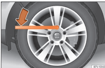
Kuva 69 Pyörän vaihto: pyöränpulttien löysäminen.
