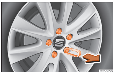
Kuva 33 Pyörä: pyöränpultit suojuksineen.
