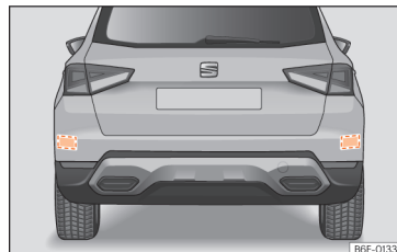
Kuva 142 Auton takaosa: tutkatunnistimien alueet.
