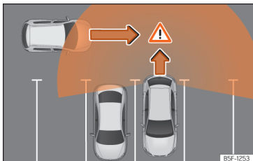
Kuva 161 Kaaviokuva poistumisavustimesta: valvottava alue auton takapuolella.
