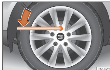
Kuva 35 Pyöränvaihto: pyöränpulttien löysäminen.
