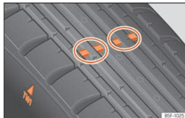
Kuva 284 Renkaan kulutuspinnan kulumisilmaisimet
