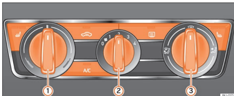
Kuva 170 Ilmastointilaitteen säätimet kojelaudassa.
