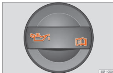
Kuva 59 Moottoriöljyn täyttöaukon korkki moottoritilassa
