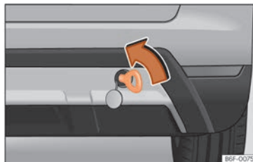
Kuva 100 Takapuskurissa oikealla: kiinni ruuvattu hinaussilmukka
