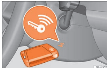
Kuva 242 Ohjauspylväessä oikealla: hätäkäynnistyspaikka.
