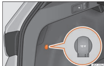
Kuva 169 Tavaratilan sivulla: 12 V:n virranulosotto.
