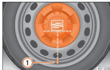
Kuva 74 Teräsvanteiden keskiökapselien oikea kiinnitys.
