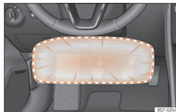
Kuva 31 Kuljettajan polviturvatyynyn vaikutusalue.
