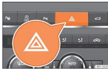
Kuva 47 Kojelauta: varoitusvilkujen kytkin.
