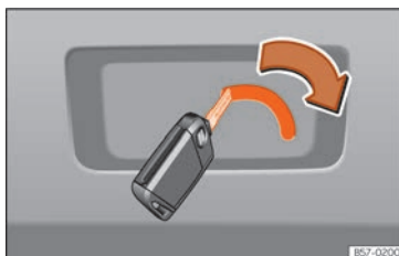
Kuva 11 Tavaratila: lukon avaus hätätilanteessa.
