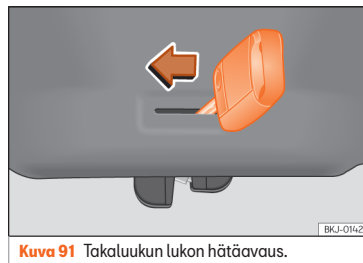
Kuva 91 Takaluukun lukon hätäavaus.
