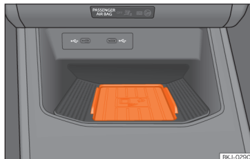
Kuva 130 Keskikonsolissa: matkapuhelimen yhdistämispaikka.
