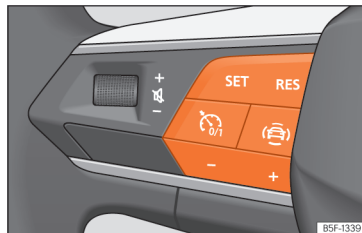
Kuva 148 Monitoimiohjauspyörä: vakionopeudensäätimen käyttöpainikkeet.
