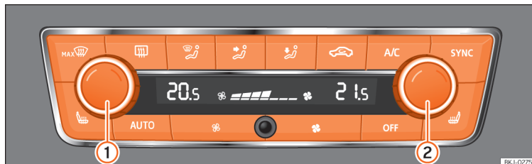
Kuva 122 Kesikonsolissa: Climatronicin käyttöelementit.
