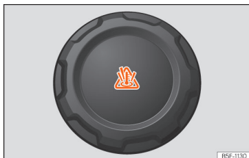
Kuva 193 Moottoritila: moottorin jäähdytysnestesäiliön korkki.
