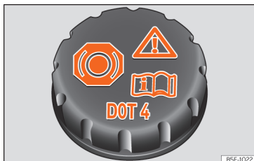
Kuva 194 Moottoritila: jarrunestesäiliön korkki.
