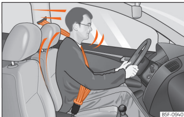
Kuva 7 Turvavyötä oikein käyttävä kuljettaja ei sinkoudu eteenpäin äkkijarrutuksessa tai -pysähdyksessä.
