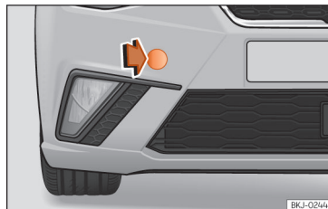
Kuva 45 Etupuskurin oikea puoli: peitekannen irrotus.
