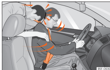
Kuva 9 Turvavyötä käyttämätön takana istuva matkustaja lennähtää eteenpäin turvavyötä käyttävän kuljettajan päälle.
