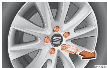
Kuva 34 Pyörä: pyöränpultti suojuksiin.
