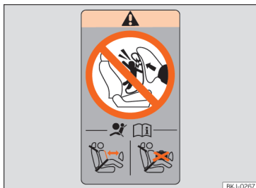
Kuva 23 Turvatyynyntarra: etumatkustajan oven takapilarissa
