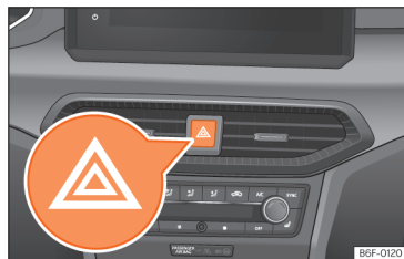
Kuva 98 Kojelauta: varoitusvilkujen kytin.
