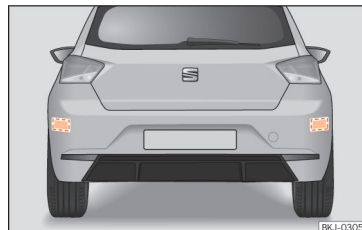
Kuva 145 Auton takaosa: tutkatunnistimien alueet.
