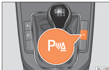
Kuva 167 Keskikonsoli: pysäköintitutkan painike (versioista riippuen).
