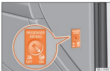
Kuva 25 Etumatkustajan eturvatyynyn kytkin.
