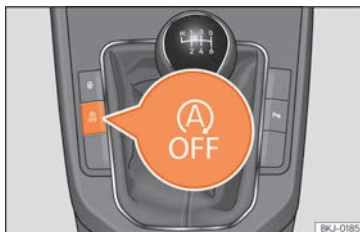
Kuva 226 Keskikonsoli: start-stop-järjestelmän painike.
