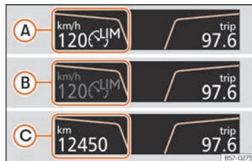
Kuva 228 Mittariston näyttöruidussa: nopeudenrajoittimen tilan näyttö.
