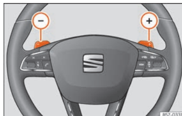
Kuva 223 Ohjauspyörä: automaattivaihteiston vaihteenvaihtimet
