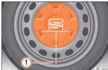
Kuva 71 Teräsvanteiden keskiökapselin oikea kiinnitys.
