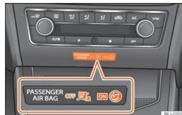
Kuva 97 Kojelaudan keskiosassa: poiskytketystä etumatkustajan turvatyynyntä kertova merkkivalo.
