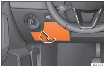
Kuva 64 Kojelaudassa kuljettajan puolella: sulakerasian kansi.
