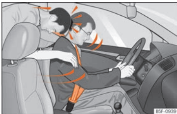
Kuva 93 Takana istuva, turvavyötä käyttämätön matkustaja lennähtää törmäyksessä eteenpäin, edessä istuvan päälle.
