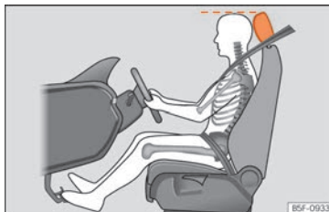
Kuva 86 Kuljettajan pääntuen oikea asento.
