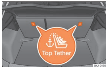
Kuva 35 Top Tether -lenkkien sijainti takaistuimen takana
