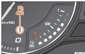
Kuva 122 Analoginen mittaristo: maakaasumittari
