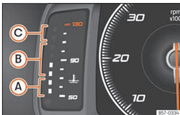
Kuva 124 Digitaalinen mittaristo: moottorin jäähdytysnesteen lämpömittari.
