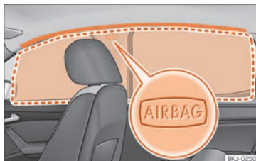
Kuva 29 Ikkunaturvaverhon sijainti ja avautumisalue.
