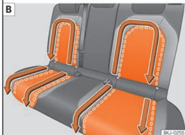
Kuva 153 Istuinsuojan irrotus. [A] vasen etuistuin; [B] takaistuimet
