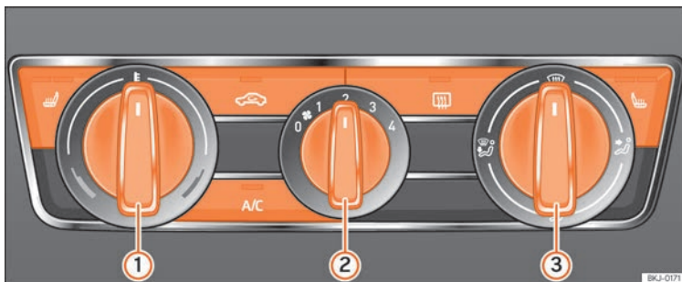
Kuva 171 Ilmastointilaitteen säätimet kojelaudassa.
