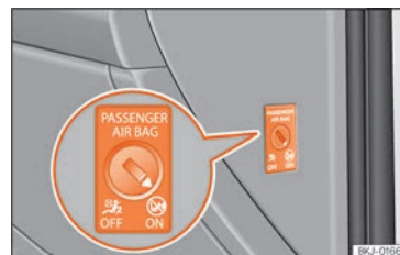
Kuva 96 Avainkytkin etumatkustajan eturvatyynyn kytkemiseksi pois toiminnasta.
