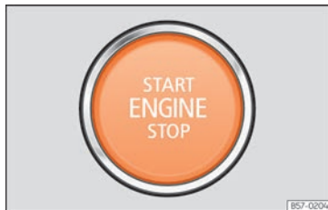
Kuva 217 Keskkonsolin alaosassa: käynnistyspainike.
