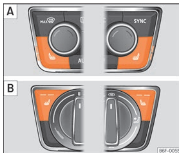
Kuva 151 Keskikonsolissa: etuistuinten lämmityksen säätimet. A: Climatronicin yhteydessä. B: manuaalisen ilmastointilaitteen yhteydessä.
