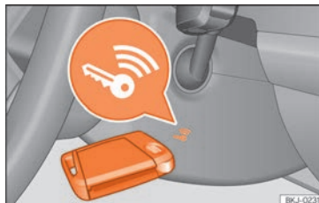
Kuva 218 Ohjauspylväässä oikealla: hätäkäynnistyspaikka.
