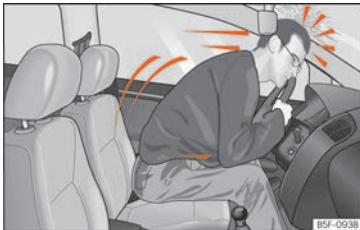
Kuva 92 Turvavyötä käyttämätön kuljettaja lennähtää törmäyksessä eteenpäin.
