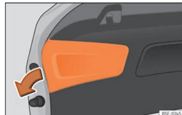
Kuva 119 Peitelevyn poisto takaluukusta.
