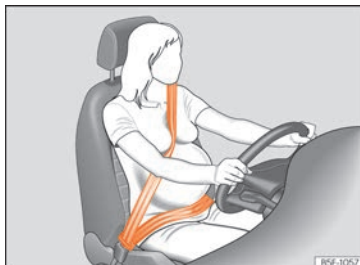
Kuva 97 Turvavyön asento ja raskaana oleva nainen.
