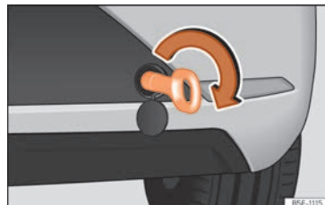
Kuva 81 Takapuskurissa oikealla: kiinni ruuvattu hinaussilmukka
