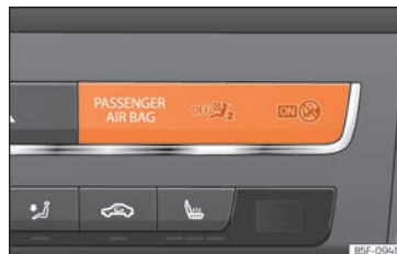
Kuva 99 Kojelauta: poiskytketyn etumatkustajan eturvatyynyn merkkivalo.
