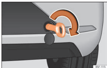
Kuva 103 Takapuskurissa oikealla: kiinni ruuvattu hinaussilmukka
