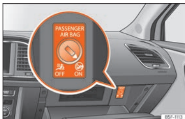
Kuva 28 Etumatkustajan etururvatyynyn kytkin.
