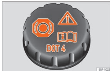
Kuva 65 Moottoritila: jarrunestesäiliön korkki
