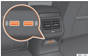
Kuva 248 Keskikonsolin takaosa: USB-liitännät.
