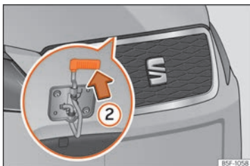
Kuva 13 Vipu konepellin alapuolella.
