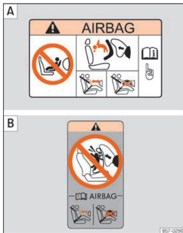
Kuva 36 Turvatyynyntarra – versio 1: etumatkustajan häikäisysuojassa [A] ja ovipilarissa [B].
