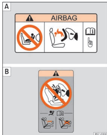
Kuva 37 Turvatyynyntarra – versio 2: etumatkustajan häikäisysuojassa [A] ja ovipilarissa [B].
