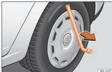
Kuva 74 Pölykapselin irrotus vanteesta.
