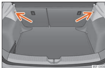
Kuva 187 Tavaratilassa: kassikoukut (Leon).
