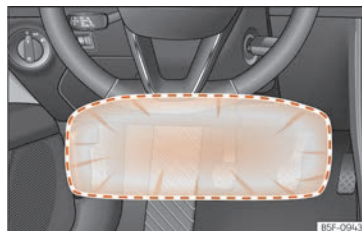
Kuva 31 Kuljettajan polviturvatyynyn vaikutusalue.
