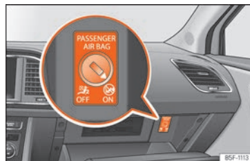
Kuva 98 Avainkytkin etumatkustajan eturvatyynyn kytkemiseksi pois toiminnasta.
