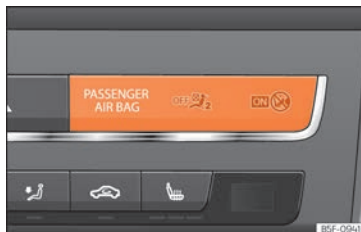
Kuva 29 Kojelauta: poiskytketyn etumatkustajan etururvatyynyn merkkivalo.
