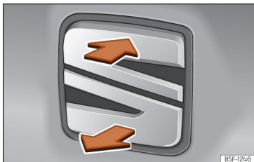
Kuva 94 Takaluukun avaus ulkopuolelta.
