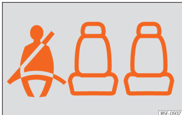
Kuva 10 Mittariston näyttö kertoo, että istuipaikka takana vasemmalla on käytössä ja kyseinen matkustaja on kiinnittänyt turvavyön.
