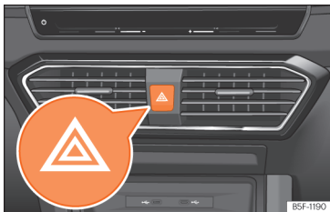
Kuva 105 Kojelauta: varoitusvilkkujen kytkin.
