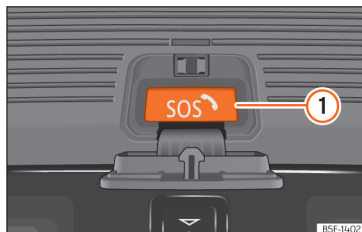
Kuva 38 Hätäpuhelupainike kattokonsolissa (varustelusta riippuen).
