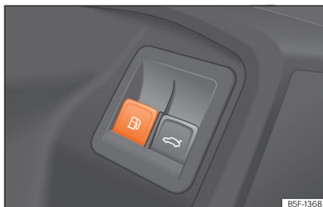
Kuva 222 Kuljettajan ovi: tankkausluukun lukon avaus.
