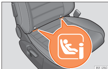
Kuva 33 Etumatkustajan istuin: ISOFIX/i-Size-pidikelenkit.
