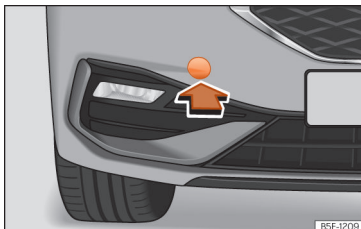
Kuva 52 Etupuskurin oikea puoli: peitekannen irrotus.
