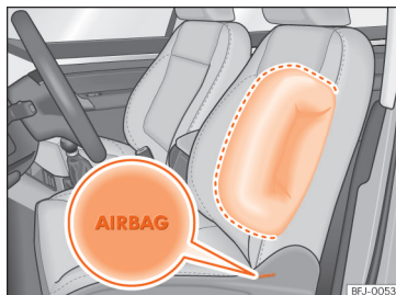
Kuva 26 Sivuturvatyyny kuljettajan istuimessa
