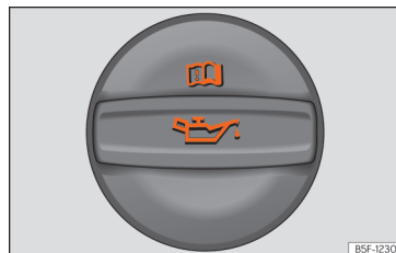
Kuva 233 Moottoriöljyn täyttöaukon korkki moottoritilassa
