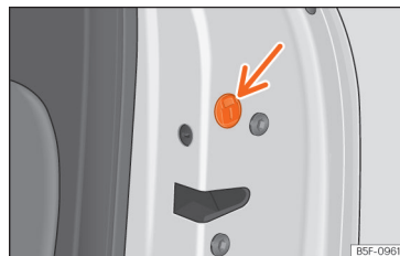
Kuva 92 Oven manuaalinen lukituspaikka.
