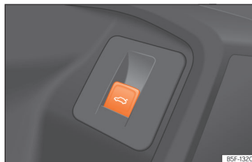
Kuva 96 Kuljettajan ovelta: takaluukun avaus- ja sulkemispainike.
