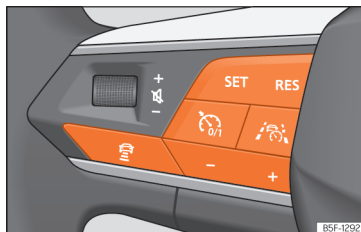
Kuva 190 Monitoimiohjauspyörän vasen puoli: Travel Assistin käyttöpainikkeet.
