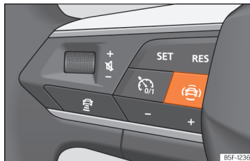
Kuva 74 Monitoimiohjauspyörässä vasemalla: kuljettajaa avustavien järjestelmien painike (mallista riippuen).
