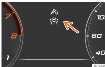
Kuva 65 Taloudellisen ajon avustimen näyttö [kaaviokuva].
