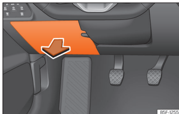
Kuva 56 Kojelaudassa kuljettajan puolella: sulakekotelon kansi.
