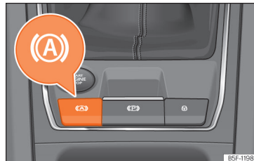
Kuva 199 Keskikonsolin alaosassa: Auto Hold -toiminnon painike.
