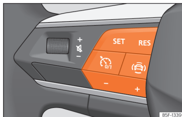
Kuva 177 Monitoimiohjauspyörässä: vakionopeudensäätimen käyttöpainikkeet.
