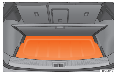
Kuva 127 Tavaratilanpeitteen asetus tavaratilaan.
