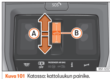
Kuva 101 Katossa: kattoluukun painike.
