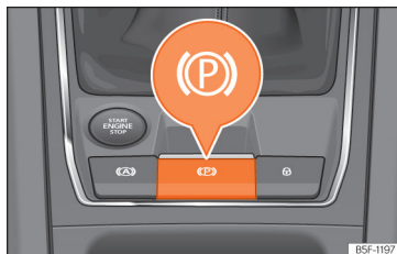
Kuva 198 Keskikonsolin alaosassa: sähköisen seisontajarrun painike.
