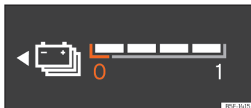
Kuva 67 Digitaalinen mittaristo: akun varaustilan näyttö.
