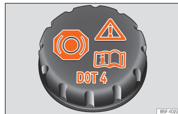
Kuva 237 Moottoritila: jarrunestesäiliön korkki.
