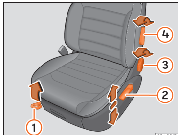
Kuva 113 Etuistuimet: manuaalinen säätö.
