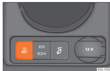
Kuva 162 Keskikonsoli: rengaspainevaroituksen painike
