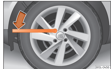
Kuva 33 Pyöränvaihto: pyöränpulttien löysäminen.
