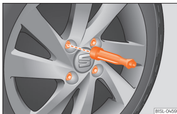
Kuva 37 Pyöränvaihto: pyöränpulttien kiertäminen irti ruuvitaltan kahvalla.
