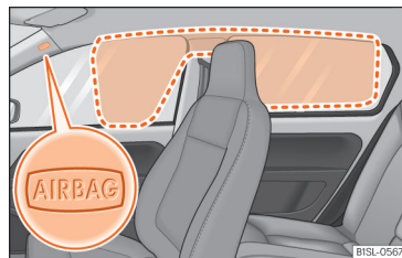
Kuva 19 Ikkunaturvaverhon sijainti ja avautumisalue.
