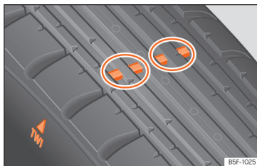
Kuva 160 Renkaan kulutuspiinta: kulumisvaroitTIMet.
