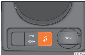
Kuva 147 Keskikonsolin alaosassa: lataustilan painike.
