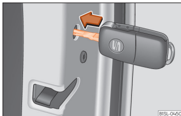
Kuva 71 Auton hätälukitseminen autonavaimella.
