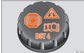
Kuva 156 Moottoritala: jarrunestesäiliön korkki
