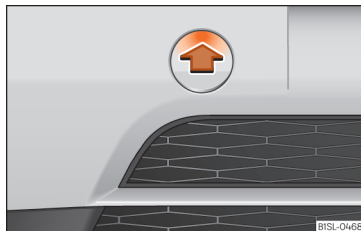
Kuva 42 Etupuskurin oikea puoli: peitekannen irrotus.
