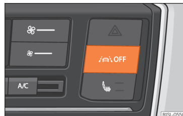
Kuva 135 Keskikonsolissa: painike kaistavahdin kytkemiseksi päälle
