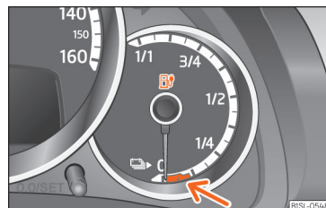
Kuva 142 Mittaristossa: korkeajänniteakun varaustilan näyttö, jossa punaisella merkitty vara-alue (nuoli).
