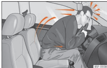
Kuva 90 Turvavyötä käyttämättömän kuljettajan lennähtää törmäyksessä eteenpäin.
