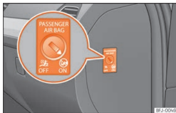
Kuva 95 Avainkytkin etumatkustajan eturvatyynyn kytkemiseksi pois toiminnasta.
