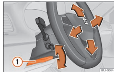
Kuva 24 Vipu ohjauspylvään alla vasemmalla. »
