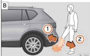
Kuva 120 Avaimeton lukitus- ja käynnistysjärjestelmä Keyless Access: A toiminta-alue. B takaluukun tunnistinohjattu avaus (Easy Open).
