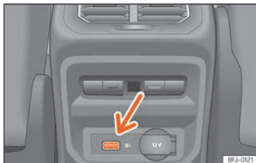
Kuva 240 Keskikonsolin takaosa: USB-liitäntä.
