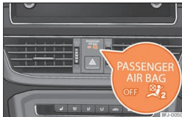
Kuva 96 Kojelauta: poiskytketty etumatkustajan eturvatyynyn merkivalo.
