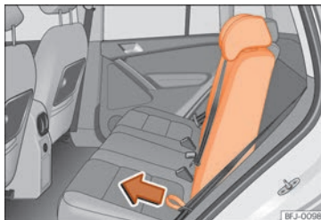
Kuva 155 Takaselkänojan kääntö eteen ja taakse.
