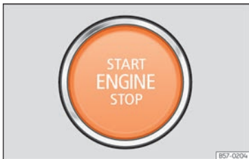
Kuva 41 Keskikonsolin alaosassa: käynnistyspainike.
