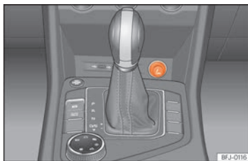
Kuva 182 Keskikonsolin alaosassa: savukkeensytytin.
