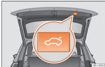
Kuva 125 Takaluukku auki: painike takaluukun sulkemiseksi.
