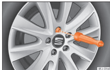
Kuva 78 Löysättyjen pyöränpulttien kiertäminen irti ruuvitaltan kahvalta.
