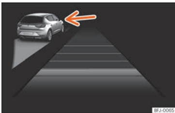
Kuva 267 Mittariston näyttöruutu: ACC aktiivinen, toinen ajoneuvo havaittu vasemmalla puolella.
