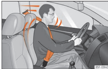
Kuva 89 Turvavyötä oikein käyttävä kuljettaja pysyy paikallaan äkkipysähdyksessä.
