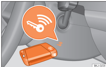
Kuva 162 Ohjauspylvään oikeassa sivussa: hätäkäynnistyspaikka.
