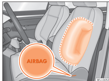
Kuva 21 Sivuturvavyönnin kuljettajan istuimessa
