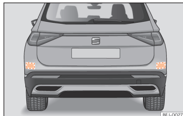
Kuva 175 Auton takaosa: tutkatunnistimien alueet.
