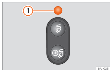
Kuva 228 Latausluukun takana: latausprosessin merkkivalo.
