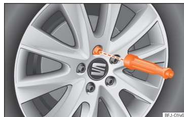
Kuva 39 Pyöränvaihto: pyöränpulttien kiertäminen irti ruuvitaltan kahvalla.
