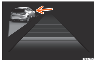
Kuva 187 Mittariston näyttö: ACC aktiivinen, toinen ajoneuvo havaittu vasemmalla puolella
