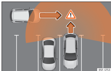
Kuva 198 Kaaviokuva poistumisavustimesta: valvottava alue auton takapuolella.
